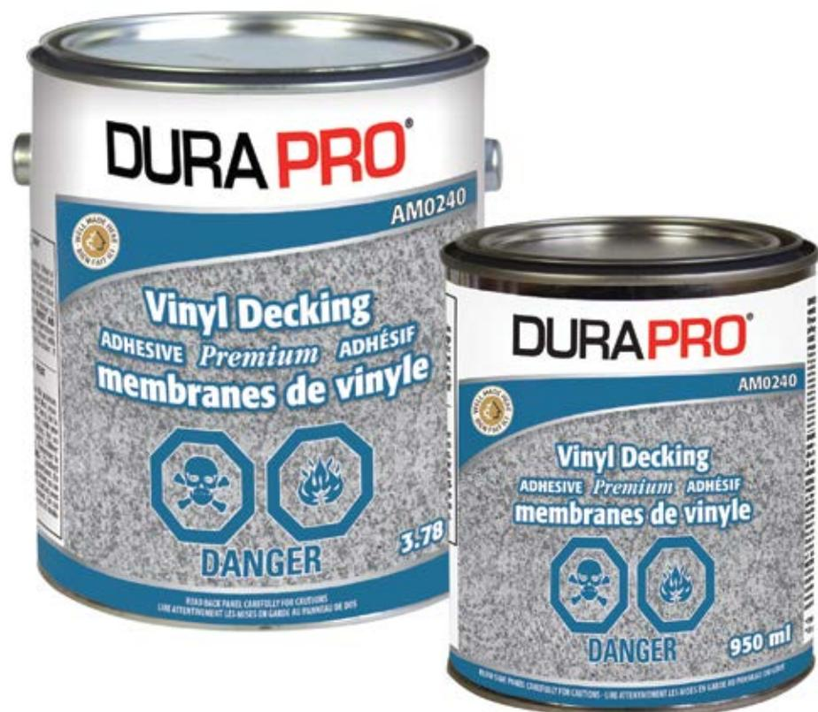
DURAPRO AM0240 est une colle contact formulée pour la pose permanente de membranes de vinyle en PVC sur contreplaqué de grade extérieur, bois traité sous pression, béton durcit. AM 0240 résiste aux conditions de température de -29°C à 49° C. AM 0240 est excellent pour coller les membranes de vinyle en PVC laminées à un endos tissé aux patios, marches, aires de jeux, terrasses et autour de la piscine pour installations résidentielles et commerciales légères.
